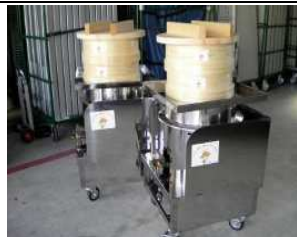
※万能ガス調理器(蒸・焼・煮) (横 600*縦 600*高さ 1000)
