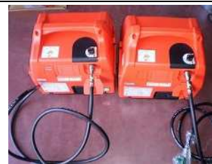
※発電機 (0.85kva) (プロパンガス対応)
